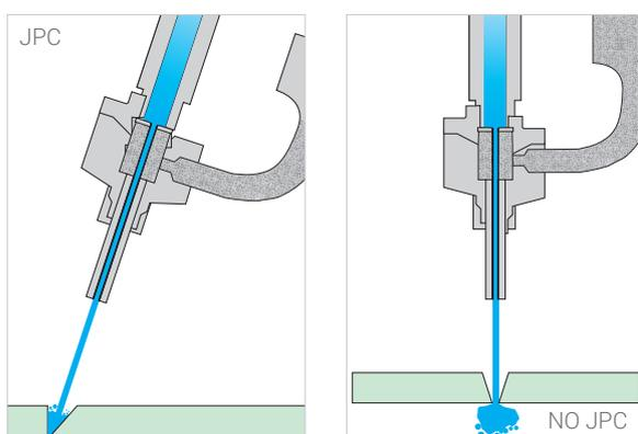
Sviluppata da Biesse, la tecnologia JPC, Jet Performance Control, massimizza l'efficienza della lavorazione in termini di rapporto qualità del profilo e velocità di taglio.
