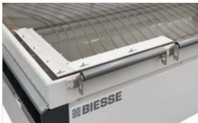
Possibilità di montare rulli anteriori e posteriori per agevolare carico e scarico dei materiali.
