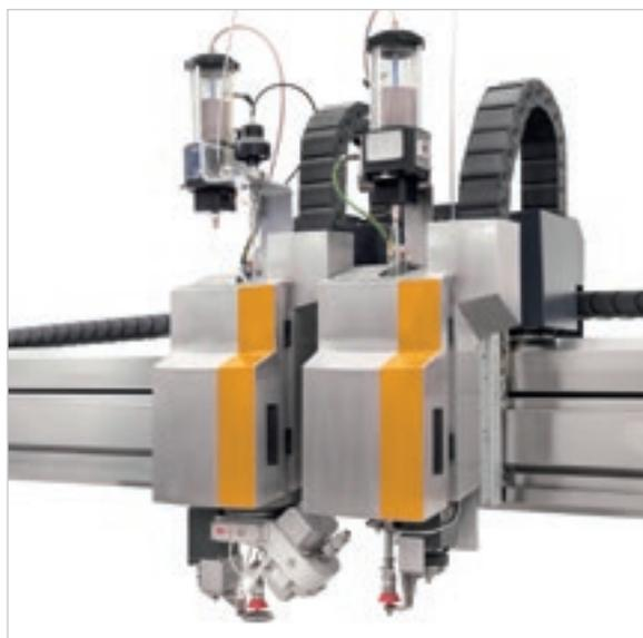
Ogni testa di taglio dotata di sistema indipendente ed automatico di gestione dell'abrasivo, assicurando in ogni momento il dosaggio ideale per ogni lavorazione
