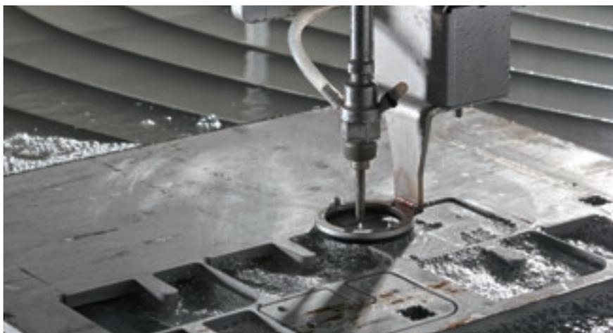
Il sistema tastatore regola automaticamente la distanza ottimale tra testa di taglio e superficie del pezzo in lavorazione, migliorando la qualità del taglio e garantendo la sicurezza durante le lavorazioni.
