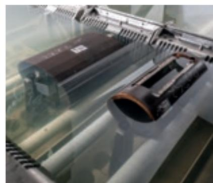
Sistemi di bloccaggio/attrezzaggio per tubi a base tonda o quadra.
